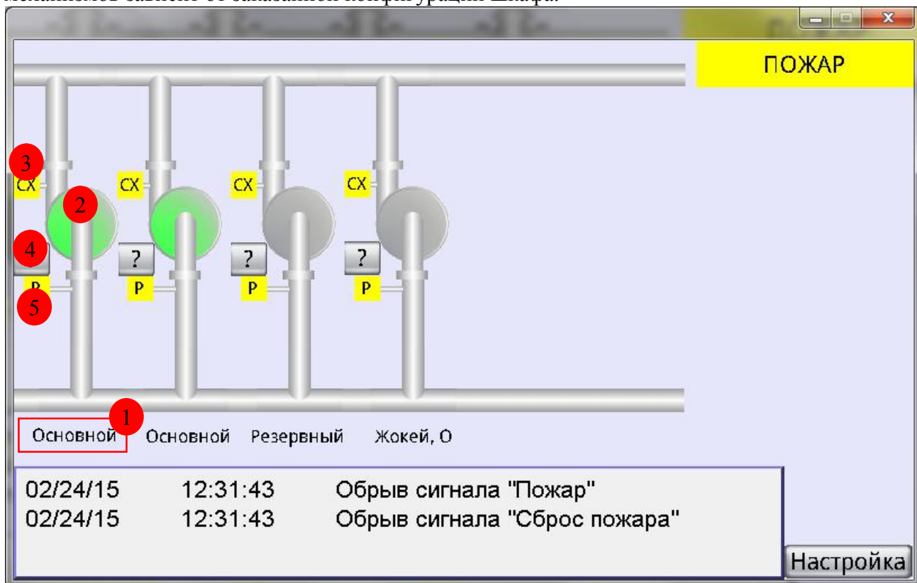
Рисунок 1. Главный экран (позиционно обозначены элементы управления 1-го насоса, для остальных назначение элементов идентично).
